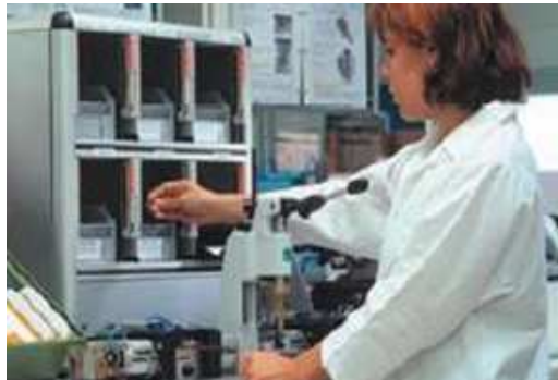
Type « Valeur constante » : Fiabilité de la mise à disposition par instructions optiques et contrôle de sélection à l'aide d'une grille lumineuse intelligente chez PSA.
